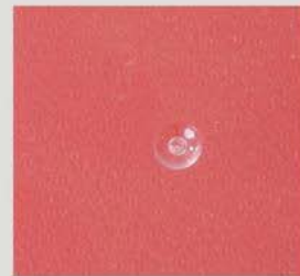
*用该喷嘴注塑成型后的浇口效果图
