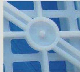
*用该喷嘴注塑成型后的浇口效果图
