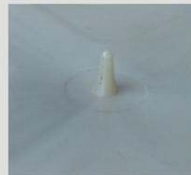
*用该喷嘴注塑成型后的浇口效果图
