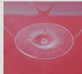
*用该喷嘴注塑成型后的浇口效果图
