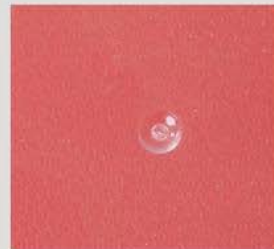
*用该喷嘴注塑成型后的浇口效果图
