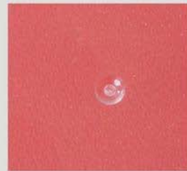
*用该喷嘴注塑成型后的浇口效果图
