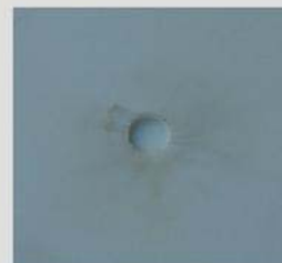
*用该喷嘴注塑成型后的浇口效果图
