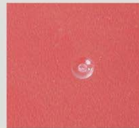
*用该喷嘴注塑成型后的浇口效果图
