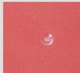
*用该喷嘴注塑成型后的浇口效果图
