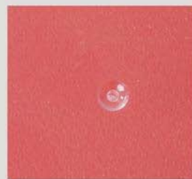
*用该喷嘴注塑成型后的浇口效果图
