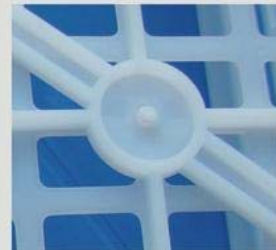
*用该喷嘴注塑成型后的浇口效果图
