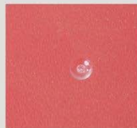
*用该喷嘴注塑成型后的浇口效果图
