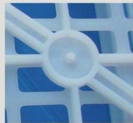
*用该喷嘴注塑成型后的浇口效果图
