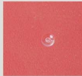
*用该喷嘴注塑成型后的浇口效果图
