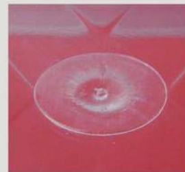
*用该喷嘴注塑成型后的浇口效果图
