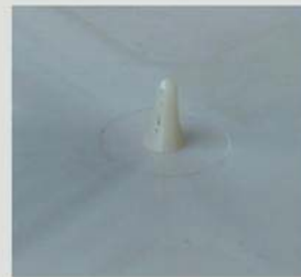
*用该喷嘴注塑成型后的浇口效果图
