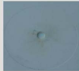
*用该喷嘴注塑成型后的浇口效果图
