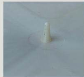
*用该喷嘴注塑成型后的浇口效果图
