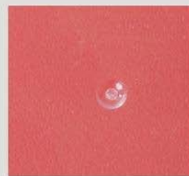
*用该喷嘴注塑成型后的浇口效果图
