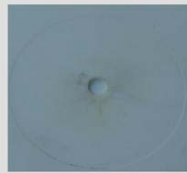
*用该喷嘴注塑成型后的浇口效果图
