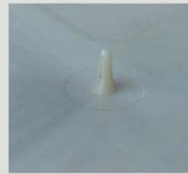
*用该喷嘴注塑成型后的浇口效果图
