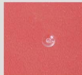
*用该喷嘴注塑成型后的浇口效果图
