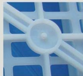
*用该喷嘴注塑成型后的浇口效果图
