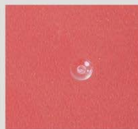
*用该喷嘴注塑成型后的浇口效果图
