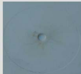
*用该喷嘴注塑成型后的浇口效果图
