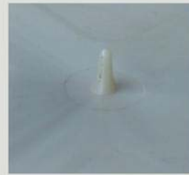
*用该喷嘴注塑成型后的浇口效果图
