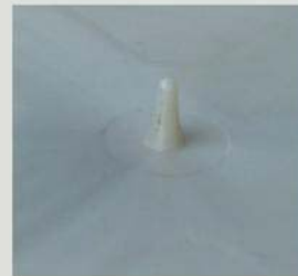
*用该喷嘴注塑成型后的浇口效果图
