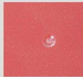
*用该喷嘴注塑成型后的浇口效果图
