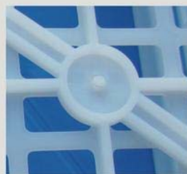
*用该喷嘴注塑成型后的浇口效果图
