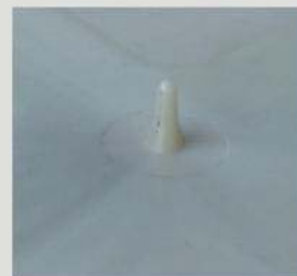
*用该喷嘴注塑成型后的浇口效果图
