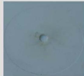
*用该喷嘴注塑成型后的浇口效果图
