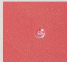
*用该喷嘴注塑成型后的浇口效果图
