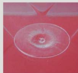
*用该喷嘴注塑成型后的浇口效果图
