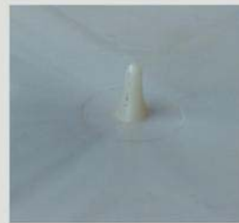
*用该喷嘴注塑成型后的浇口效果图
