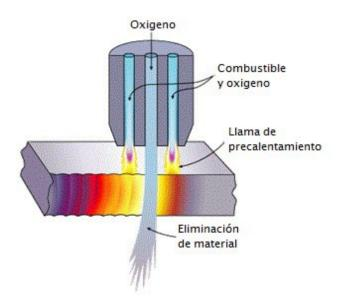
Este proceso presenta una precisión en el corte más baja que el chorro de agua o el láser, pero el bajo costo del equipamiento y la velocidad de corte que presenta hace que siga siendo competitivo. Este equipamiento puede ser utilizado manualmente o equipado en una máquina.
