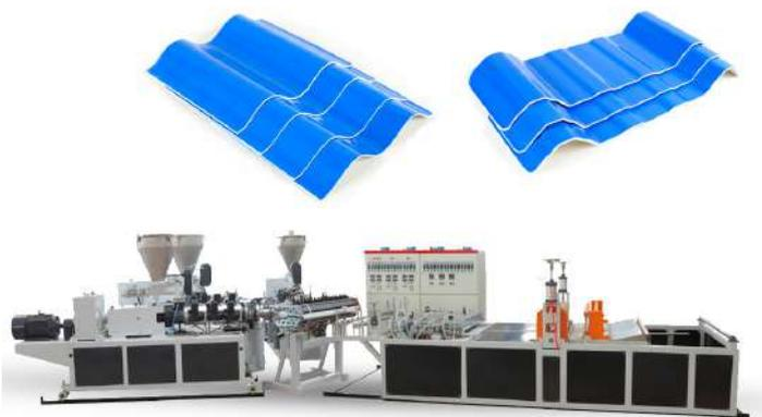
La línea de extrusión de tejas corrugadas de PVC se compone de una extrusora de tornillos cónicos gemelos y la correspondiente máquina calibradora, de arrastre y cortadora. Ventajas:
