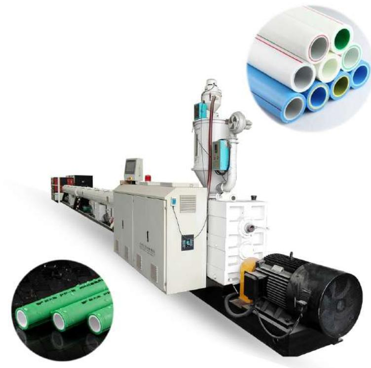
La máquina de tubos PPR se utiliza principalmente en la producción de tubos con material de resina PPR, que también se utiliza en resina PB PC PE.
