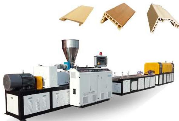
Esta línea de producción está diseñada para la extrusión de perfiles para ventanas y puertas de plástico de PVC y tubos de cables de sección transversal, perfiles compuestos de aluminio y plástico, etc. Los perfiles de PVC se utilizan ampliamente en la industria de la construcción, decoración del hogar y la oficina. Esta línea presenta plastificación estable, alto rendimiento, baja fuerza de corte, servicio de larga duración y otras ventajas.
