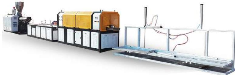
Capacidad máxima de 100 a 300 kg/h. Anchura de perfil de 108 a 600 mm.
