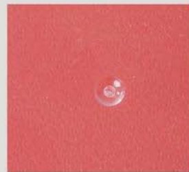
*用该喷嘴注塑成型后的浇口效果图
