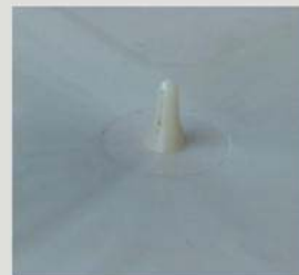
*用该喷嘴注塑成型后的浇口效果图
