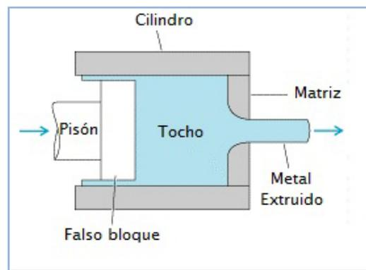
Gran cantidad de secciones transversales son fabricadas por este método. Las secciones producidas deben ser uniformes en toda la longitud de la pieza extrusionada.
