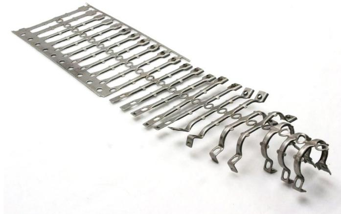
La estampación por matrices sucesivas es un proceso muy rentable y muy utilizado para producción en masa de componentes, que requieren operaciones de estampación complicadas, porque puede ser completamente automatizado y posee una alta precisión dimensional. Esta especialmente extendido para la fabricación de grandes series de piezas de pequeño o mediano tamaño.
