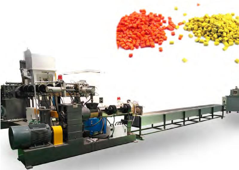
Equipo especializado en el granulado de escamas de POLIPROPILENO (PP) Y POLIETILENO (PE).
