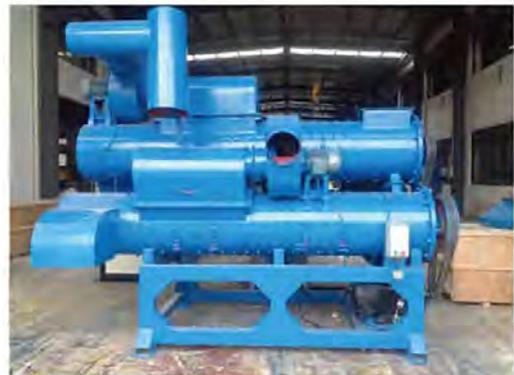
El removedor de etiquetas se puede dividir en dos categorías: removedor de etiquetas de un eje, removedor de etiquetas de tres ejes. Pueden quitar la etiqueta de plástico usando la succión de aire y la fricción de la cuchilla. El removedor de etiquetas de un solo eje puede quitar la etiqueta en un 95% y una relación de eliminación del 100% con gran capacidad mediante un removedor de etiquetas de tres ejes.
